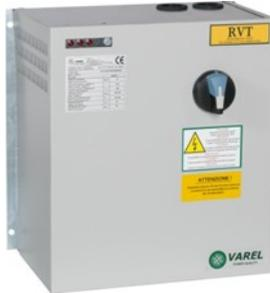
Apparecchiatura di rifasamento fissa adatta per rifasamento della paret a vuoto dei trasformatori di media tensione. Costruita su carpenteria verniciata RAL 7035 e completa di sezionatore bloccoporta, fusibili di protezione della batteria di condensatori trifase. Spie di segnalazione presenza rete e segnalazione stato fusibile. Installazione a parete con ingresso cavi dall'alto.
